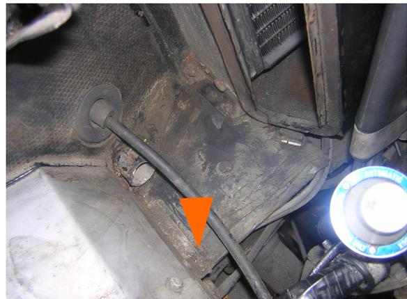
*fig 19 durite déposée, emplacement du boulon (caché sous la crasse)*
