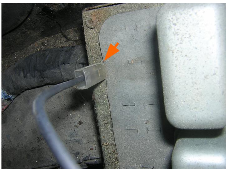
fig 25 cette fiche relie le Scintilla au circuit imprimé côté relais
