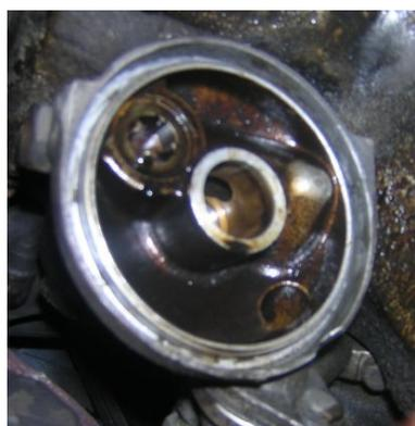
Voici la partie du moteur à laquelle s'adapte le logement du filtre. La rigole circulaire en aluminium reçoit le joint d'étanchéité (retiré ici)
