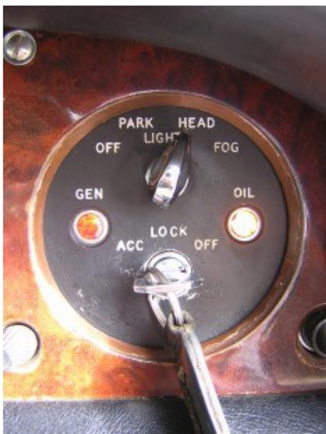
Remplir le carter d'huile aux  $\frac{3}{5}$  env. 4,5 litres et démarrer le moteur jusqu'à extinction du voyant de pression OIL d'huile situé à droite de la clé de contact.
