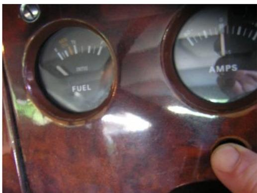
C'est éventuellement le moment de vérifier que votre bouton de test rapide de niveau d'huile fonctionne correctement. Rétablir l'électricité, mettre le contact (sans démarrer !) et appuyer sur le bouton qui jouxte la jauge d'essence. En toute logique l'aiguille blanche de la jauge « fuel » ne doit pas bouger.
