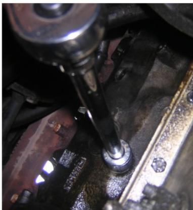
Remontage de la vis de vidange du radiateur (11mm). Pas évidente à serrer. Pour moi la position la plus simple est s'allonger parallèle au parechoc, tête vers la roue avant gauche.
