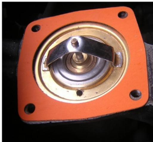
Ici on voit un thermostat neuf « compatible » Stant. En réalité, manquait un joint caoutchouc servant à caler le thermostat dans son logement j'ai donc dû remettre l'ancien thermostat d'origine.
