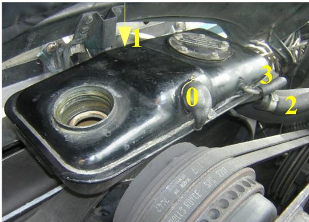
Ce vase est fixé sur le haut du radiateur par trois vis de 11 mm. Une sonde de niveau de liquide est fixée en son centre (0). Deux durites souples sont à retirer : celle qui relie le vase d'expansion au radiateur (*bleed hose* située à l'arrière du vase d'expansion) (1) et celle qui va à la pompe à eau *bypass hose*, située devant à droite (2) . Il y a aussi une durite de trop-plein *radiator escape hose* qui plonge vers le bas du moteur (3)
