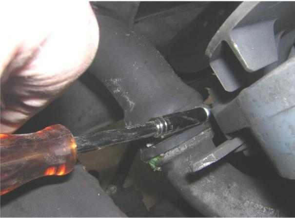
La durite supérieure a déjà été démontée pour faciliter la dépose du vase d'expansion (voir ci-dessus). Il reste à dévisser la durite inférieure. Qui sur la photo se révèle très sale.
