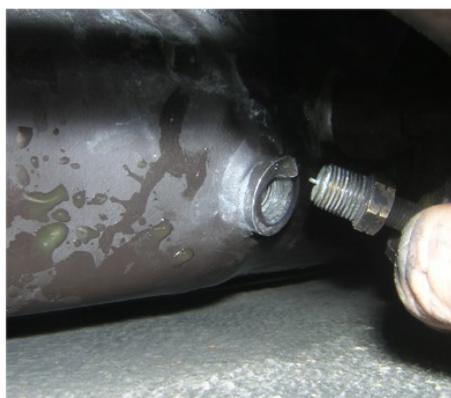
Remontage du thermostat. En profiter pour nettoyer les contacts du logement avant de le remonter.
