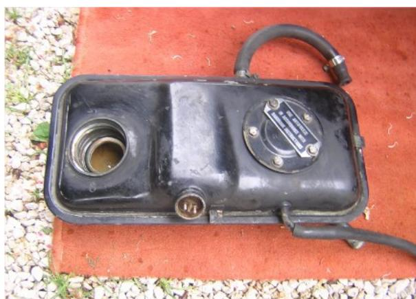
On peut maintenant retirer les 3 vis de 11 (celles de droite sont moyennement accessibles) et déposer le vase d'expansion. Il est possible de le démonter (retirer la sonde, retirer la valve de pression) mais pas l'ouvrir complètement : il est soudé.
