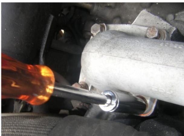
Remontage de la durite haute du radiateur. Tournevis et douille de 7mm.
