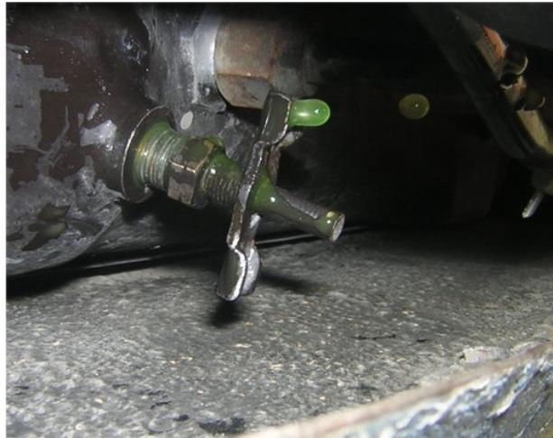
Placez sous le véhicule une bassine de vidange pouvant contenir facilement 10 à 12 litres.
