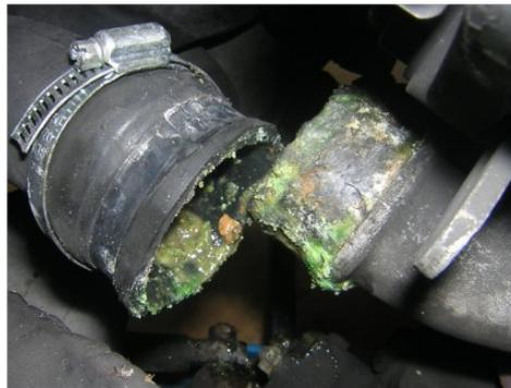
On introduit alors un tuyau et de l'eau sous pression dans la durite supérieure afin de nettoyer le radiateur. L'eau d'évacue par la durite inférieure. Laisser couler un certains temps jusqu'à ce que l'eau, brune au départ, sorte plus ou moins « claire ». Plusieurs seaux sont nécessaires. Le manuel préconise 30 minutes de circulation d'eau.
