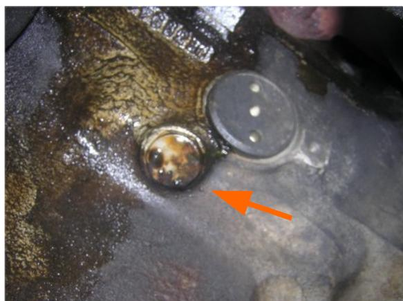
Là aussi, pour éviter une douche, dévisser très progressivement et laisser la pression s'échapper avant de retirer complètement la vis. Sur la photo ci-dessous droite, on peut constater le sédiment qui s'était accumulé au fond du bloc moteur.
