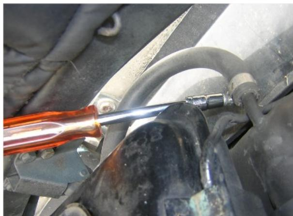
Pour accéder aux vis de droite de qui fixent le vase d'expansion à ses pattes de fixation, il faut commencer par retirer la grosse durite qui relie le radiateur au thermostat.
